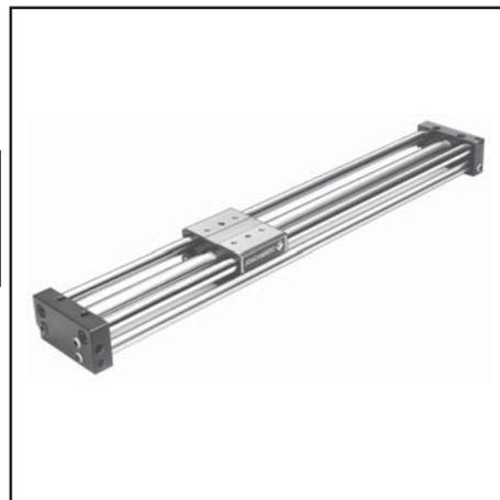
VELOCIDAD MAX. DEL CARRO : 0,5 m/s (este límite máximo permite evitar el desenclavamiento magnético de la carga).
