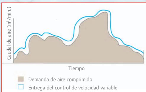
La salida de aire del Nirvana está controlada por un accionamiento de velocidad variable. El accionamiento de velocidad variable (VSD) del Nirvana de 5.5-30 kW mantiene un perfecto control sobre la presión del sistema, ajustando automáticamente el aire comprimido entregado con la finalidad de poder alcanzar la mayor eficiencia posible para su producción.
