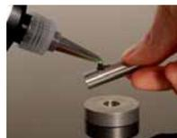
Retenedor de máxima resistencia. Para el montaje permanente de manguitos de polea o de engranajes en los ejes.
