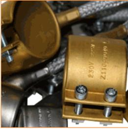
Las resistencias de boquilla hermética son ampliamente utilizadas en el sector de la inyección de plásticos, para calentar la última zona del tránsito de la materia plástica taya líquida, previa a su entrada en el molde.
